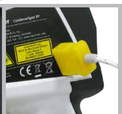
Anschluss für K-Type Thermofühler
