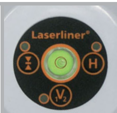
Einzel schaltbare Laserlinien
