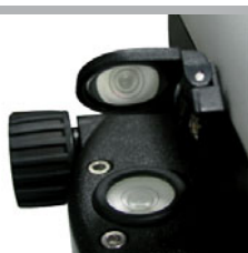
Miroir rabattable garantissant un alignement simple
